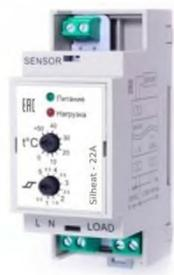
Предназначен для работы с любыми видами электрических «теплых полов» (пленочных, кабельных, электроводяных), а также для обогрева трубопроводов. Рекомендуется для тех случаев, когда пользователи не хотят, чтобы терморегуляторы щелкали в комнате и выносят терморегулятор в силовой щит в отдельное помещение.
