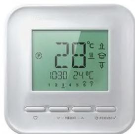
Терморегулятор 520 предназначен для управления электрическими системами обогрева помещений (нагревательными матами, плёночными нагревателями или кабельными секциями). Терморегулятор поддерживает комфортную температуру обогреваемой поверхности и обеспечивает рациональный расход электроэнергии. Терморегулятор обеспечивает управление по двум датчикам температуры: пола и воздуха, как одновременно, так и по отдельности (входят в комплект поставки).
