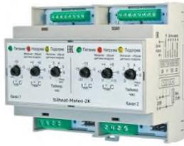
Метеостанция Silheat-Meteo-2K содержит два независимых канала управления и предназначена для оттаивания и предотвращения образования льда и снега на крышах, водостоках, площадках, ступенях, дорожках и т.д. К каждому каналу можно подключить свой датчик температуры, осадков и нагрузки.
